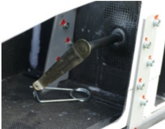
Flügelbolzen bereit zum Durchstecken durch den Holm
