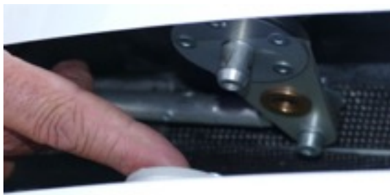
Die Verbindungen für die Steuerung müssen vor dem Zusammenstecken fluchten.
