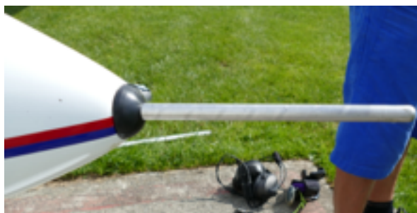
Pitotrohr vollständig heraus gezogen
