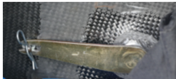
Flügel-Verbindungsbolzen im Cockpit mit Klemmbügel-Sicherung
