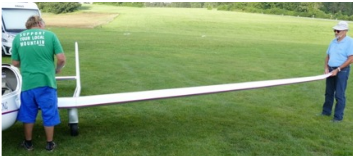
Holmstummel komplett eingeschoben; Flügelspitze auf und ab, bis der Verbindungsbolzen passt
