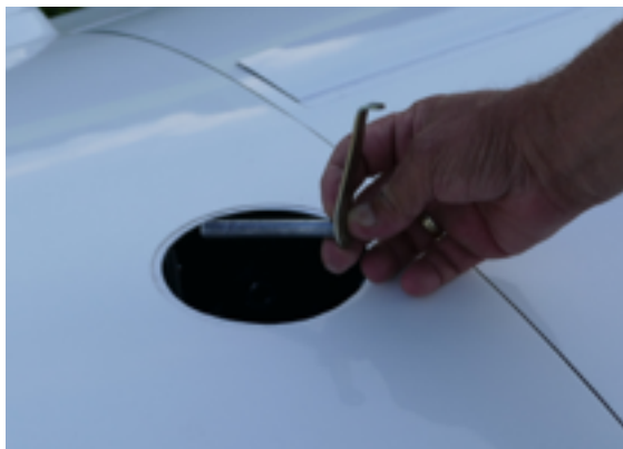
Verbindungsbolzen am Flügelstummel
